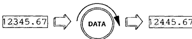
Maintenant, si le bouton CURSOR est tourné d'un pas dans le sens des aiguilles d'une montre, les quatre premiers chiffres seront sélectionnés 12445.67, et un pas du bouton DATA dans le sens des aiguilles d'une montre produira: 12455.67.
